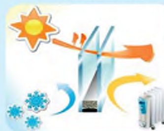
Мал. 25. Приклади використання теплопровідності повітря
