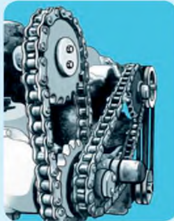
Мал. 122. Приклади пасових і ланцюгових передач
