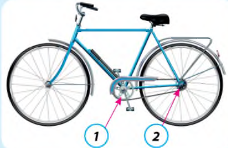
Мал. 118. Ланцюгова передача у велосипеді: 1 — повідна шестерня; 2 — ведена шестерня
