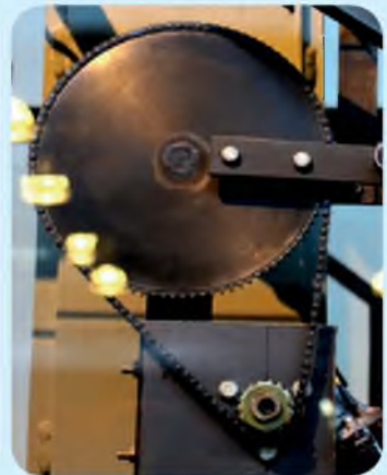
Мал. 122. Приклади пасових і ланцюгових передач
