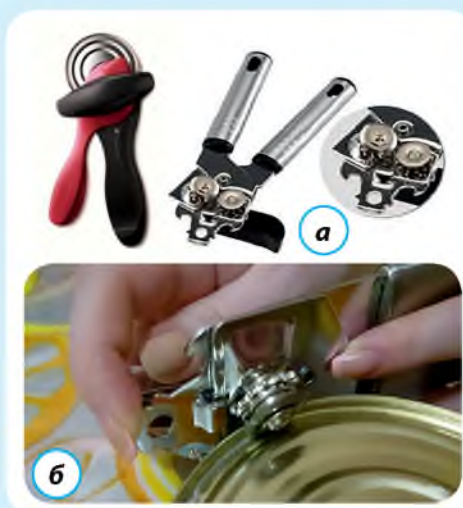
Мал. 123. а — приклади консервних ножів; б — використання консервного ножа для відкривання металеві банки
