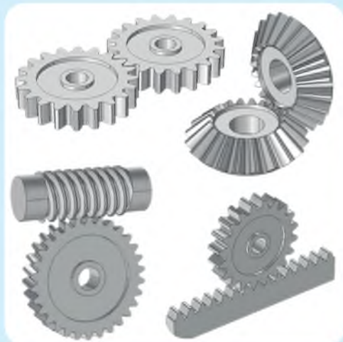
Мал. 134. Зубчаста передача (пряма, конічна, черв'ячна, рейкова)
