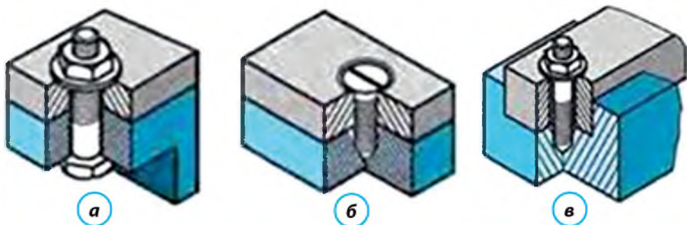
Мал. 128. Види різьбових з'єднань: а — болтове; б — гвинтове; в — шпилькове
