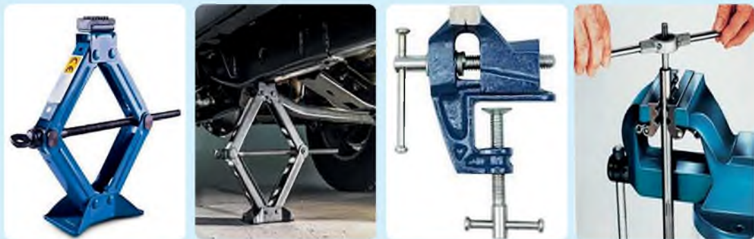
Мал. 111. Використання силових гвинтів
